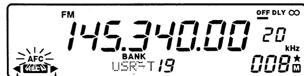
自動周波数制御機能が動作中は点灯し、同調がとれると消灯する
